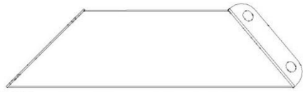
D04 CORBEAU - A4M01830 (x1) 2 3/4 po x 5 11/16 po x 20 1/16 po (70x145x509)
