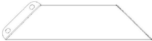
D02 CORBEAU - A4M01818 (x1) 2 3/4 po x 5 13/16 po x 22 1/4 po (70x147x565)
