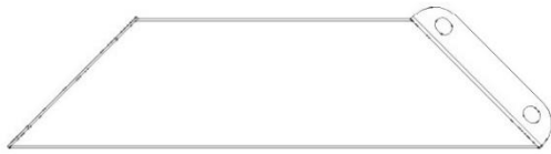
D01 CORBEAU - A4M01817 (x1) 2 3/4 po x 5 13/16 po x 22 1/4 po (70x147x565)
